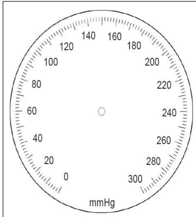
Figura 1. Ejemplo de la escala de un manómetro aneróide (división en mmHg sin zona de tolerancia en cero)<sup>1</sup>.
